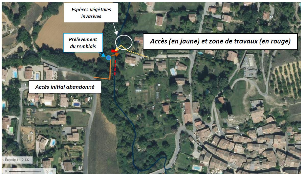
Figure 3 : Zone de prélèvement du remblai pour la fabrication de la fascine / zone d'accès au chantier.
